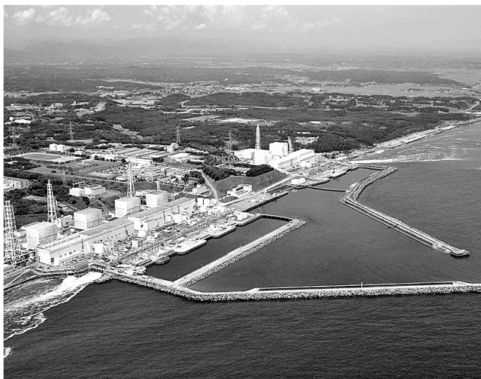
La centrale di Fukushima Dai-ichi, con i suoi sei reattori. Le prime quattro unità, quelle coinvolte dall'incidente, si trovano sulla sinistra. Davanti a esse sono visibili gli edifici turbine. A sinistra è ben visibile anche il canale di scarico a mare dell'acqua di raffreddamento (fonte: TEPCO).
